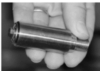
Рис. 4.7. Америцій-берилієве джерело нейтронів для каротажних зондів (фото з Sandia National Laboratory)
