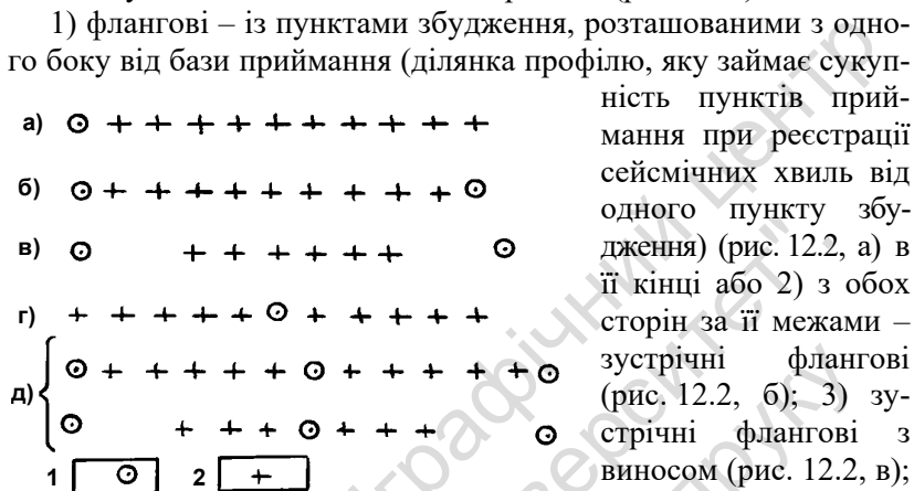
Рис. 12.2. Типи систем спостережень: а) флангова; б) зустрічна флангова; в) зустрічна флангова з виносом; г) центральна; д) комбінована; 1 – пункти збудження; 2 – пункти приймання
