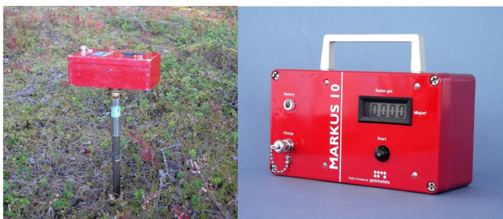
Рис. 27 – Радиометр радона "Маркус-10"
