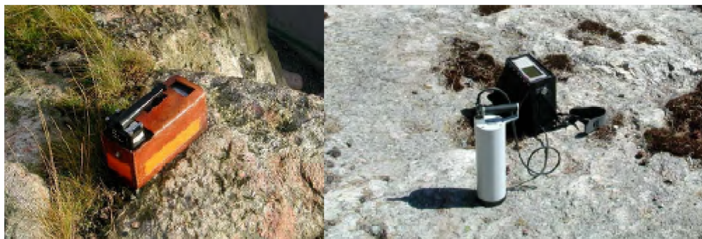
Рис. 65 – Определения радия, тория и калия из почвы и фундамента с использованием гамма-спектрометрических измерений (SGU – Геологическая служба Швеции)
