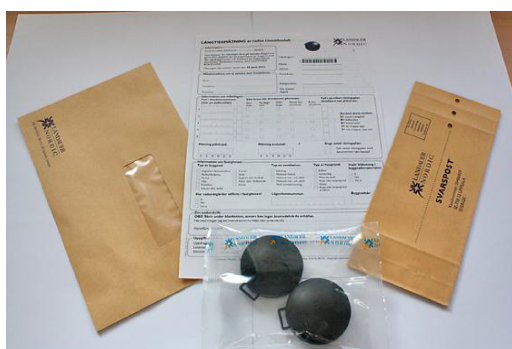
Рис. 38 – Почтовая рассылка детекторов вместе с инструкцией и опросчиком (Landauer Nordic, Швеция)
