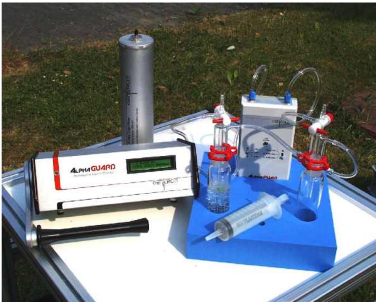
Рис. 29 – Непрерывный монитор радона AlphaGUARD (saphymo.de)
