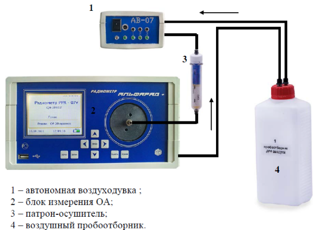
Рис. 21 – Схема измерения активности радона-222 в пробе воздуха
