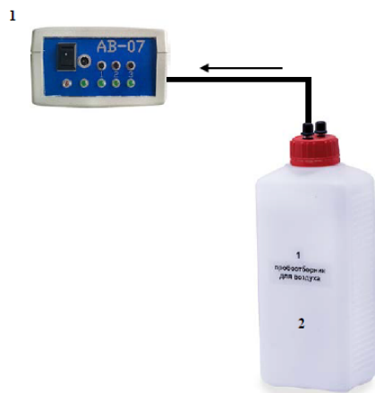
Рис. 20 – Схема перевода проб воздуха в воздухозаборное устройство
