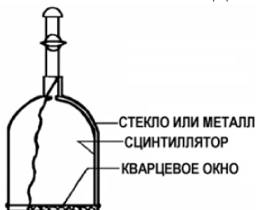
Рис. 8 – Простейшая сцинтилляционная камера для измерения концентрации радона (ячейка Лукаса)
