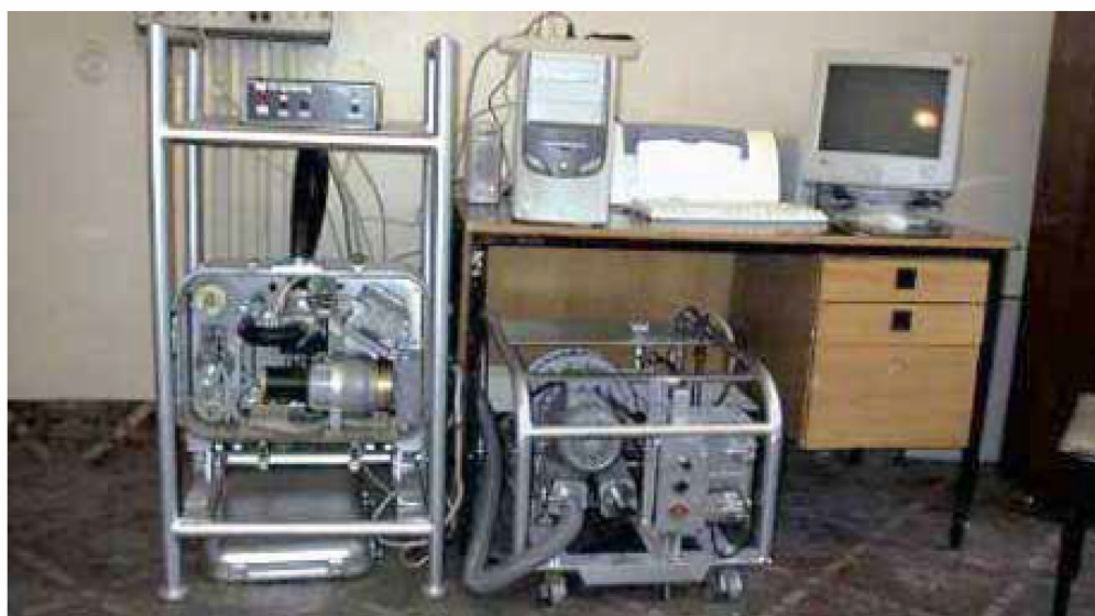
Рис. 28 – Бета, гамма-спектрометрический анализатор аэрозолей «Жасмин»
