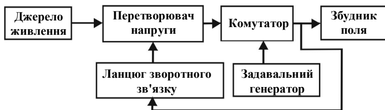
Рис. 3.1. Загальна блок-схема генераторних установок
