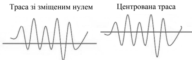
Рис. 7.1. Зміщена та центрована траса
