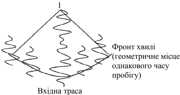
Рис. 13.6. Формування хвильового фронту по одній вхідній трасі (міграція за допомогою хвильових фронтів)
