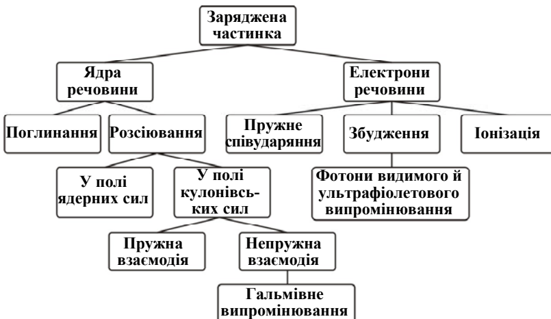
Рис. 2.2. Схема взаємодії заряджених частинок з речовиною
