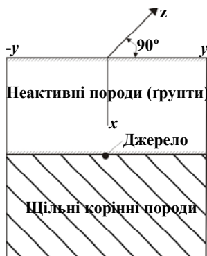
Рис. 4.13. Пояснення до розрахунку концентрації еманції в геологічному середовищі від лінійного джерела
