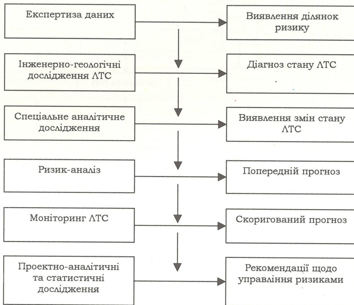
Рис. 3.4. Схема реалізації моніторингу стану ЛТС майданчика АЕС
